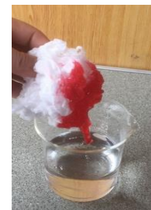
3、ハイパートラッパーを引き上げ処理完了 (白い所はまだ吸着が可能)
